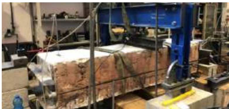
Figura 3. Applicazione della griglia CRM al provino testato in compressione diagonale
