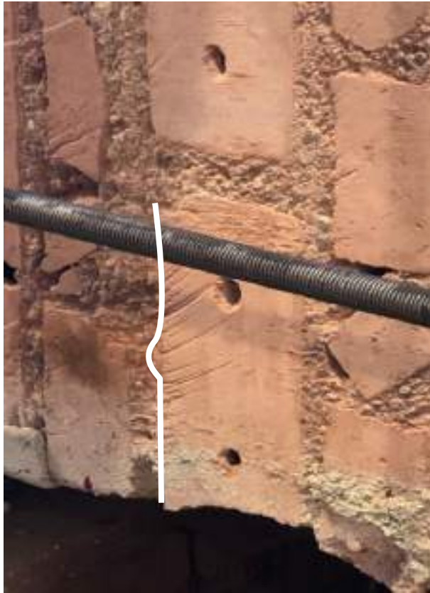
Figura 5.a a) Rottura a flessione del provino F_NR_1
