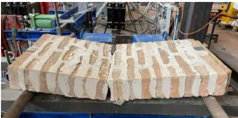
Rottura del provino di controllo (Control)
